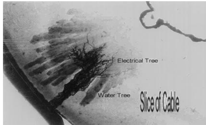
Fig 1. Formación de arborescencia acuosa a arborescencia eléctrica.
