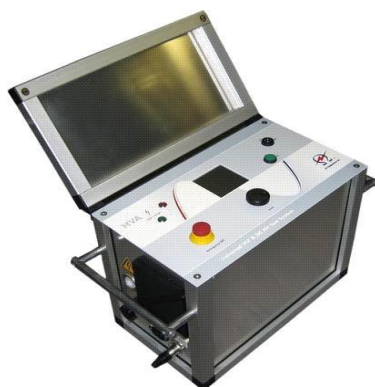
Fig 3. Equipo de VLF con opción para tangente de delta y descargas parciales.
